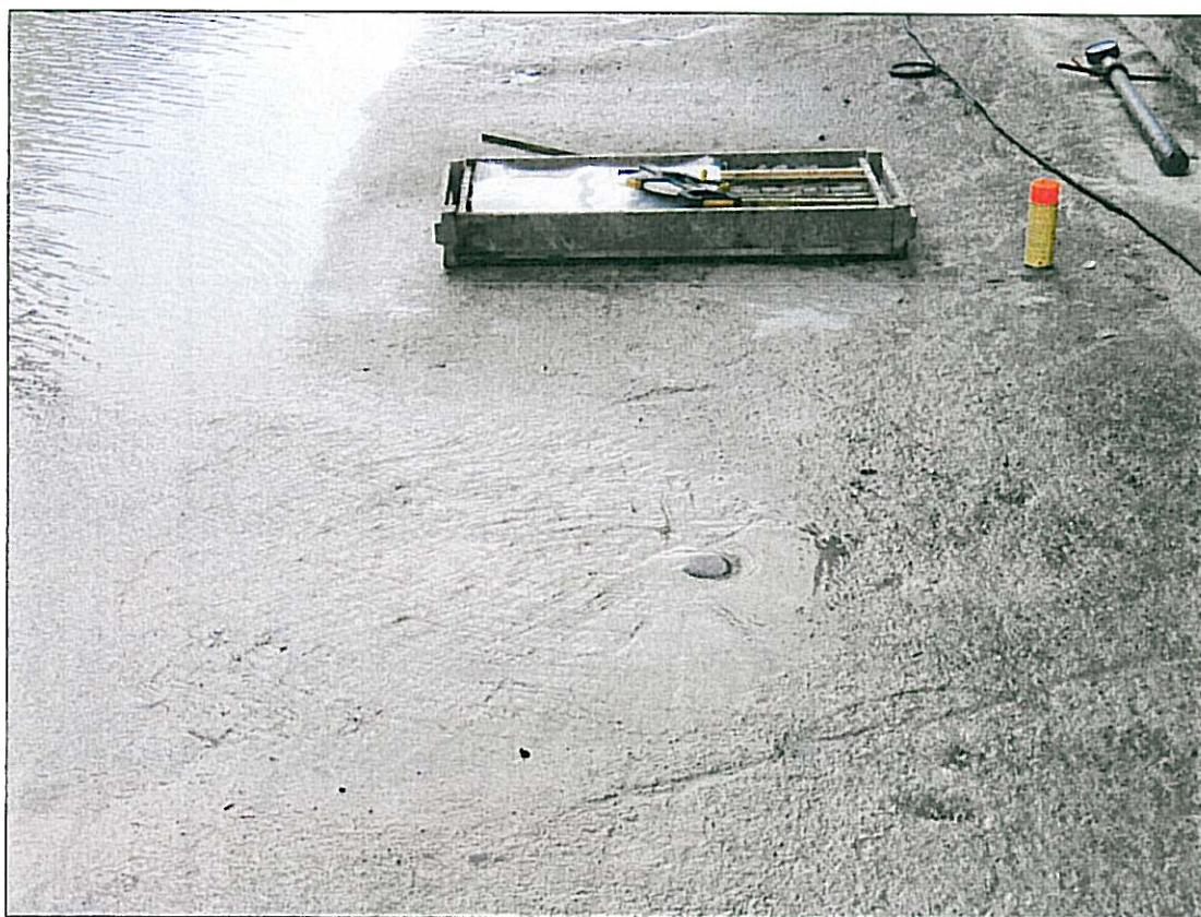
Obr. č. 4: Vývěr vody z vrtu S-3
